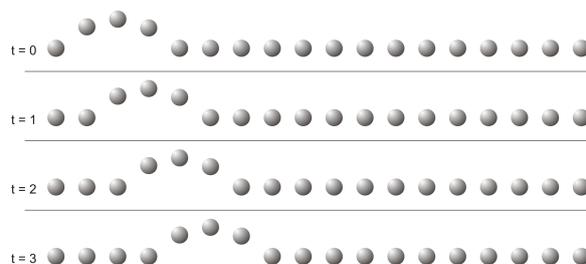
Die Welle besteht aus einem Wellenberg, der nach rechts wandert. Die Bewegung der Welle und die Bewegung der Atome der Eisenstange sind zwei verschiedene Bewegungen. Die Atome selber pendeln nur nach oben und nach unten. (Auch die Wassermoleküle bewegen sich nur auf und ab, während der Wellenberg sich über den See bewegt.)
